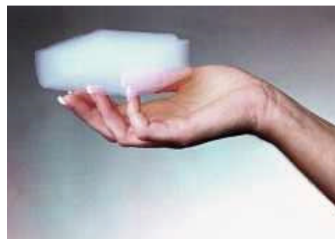
Eine sehr geringe Dichte im Feststoff, ein ebenso geringer Feststoffgehalt sowie Poren im Nanobereich sind die Besonderheiten der High-Tech-Aerogele. Bild: NASA/JPL-Caltech
