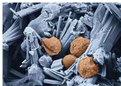
REM-Aufnahme von Micronal in Gipskristallen: Der gekapselte Latentwärmespeicher kann Baustoffen zugesetzt werden, ohne dass sich deren Verarbeitungseigenschaften grundsätzlich verändern. Bild: BASF
